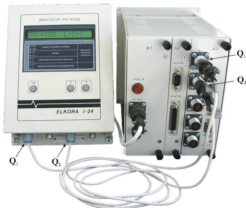
Рис 3.2. Определение относительной погрешности измерения расхода теплосчетчика с помощью имитатора расхода ELKORA I-24
